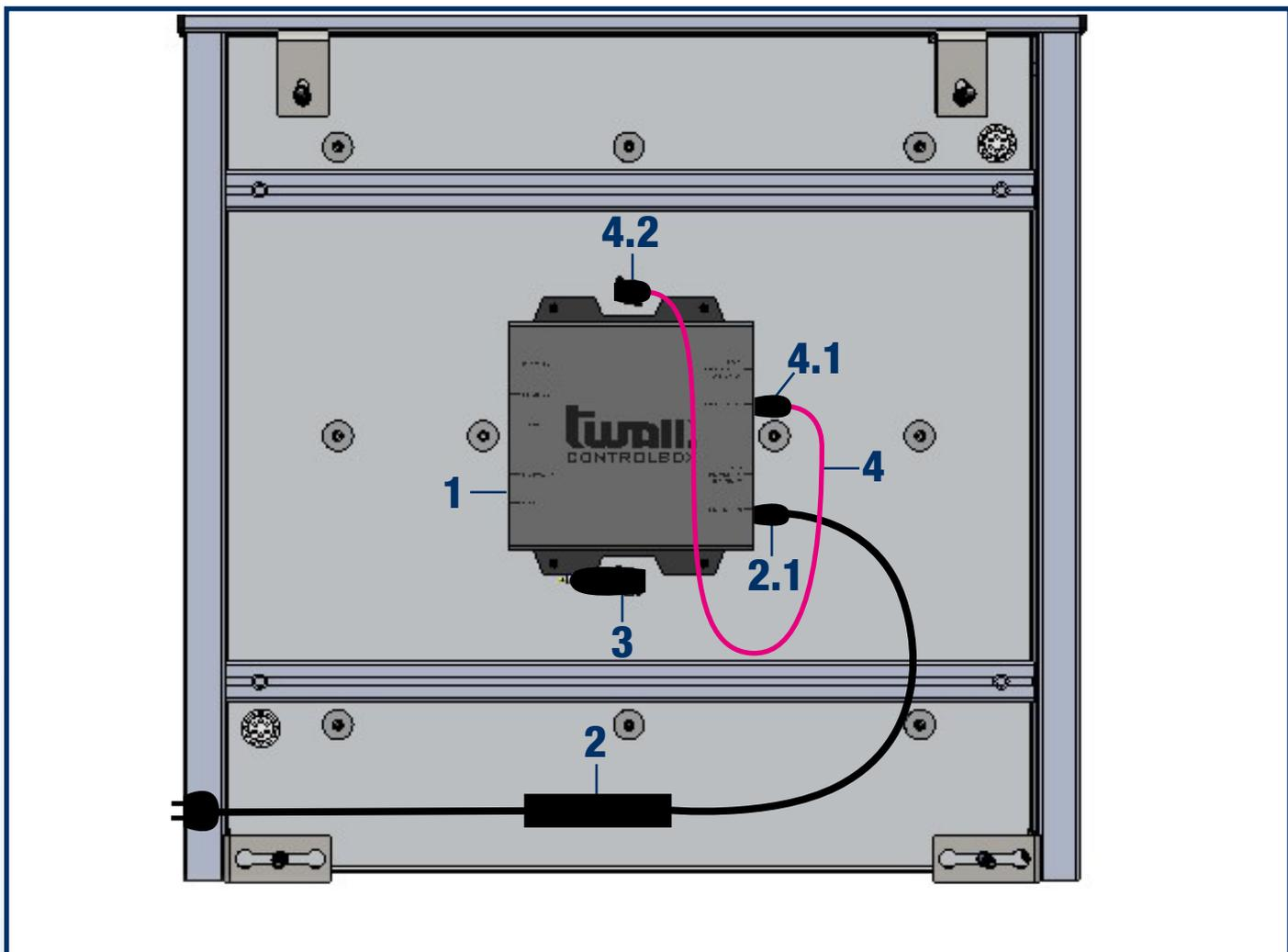
Nachfolgend wird die Verlegung der Anschlussleitungen für die twall® D1 (massive Variante) beschrieben.
