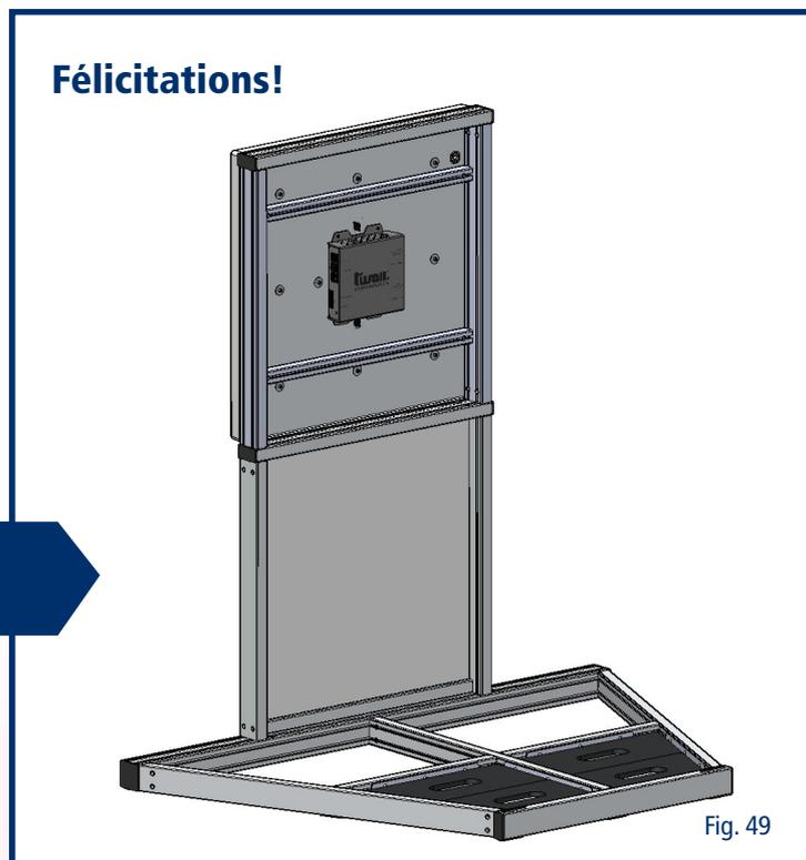
Vous venez de terminer le montage du twall® D1 sur le châssis support. Passez maintenant au montage des supports. (voir page 64)
