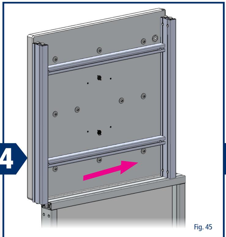
Posez le module twall® sur le profilé 80x40x880 mm du châssis support de manière à ce que les ancrages inférieurs s'insèrent dans les alésages de montage correspondants. Poussez le module vers la gauche de manière à ce qu'il repose sur le châssis support en affleurant des deux côtés.
