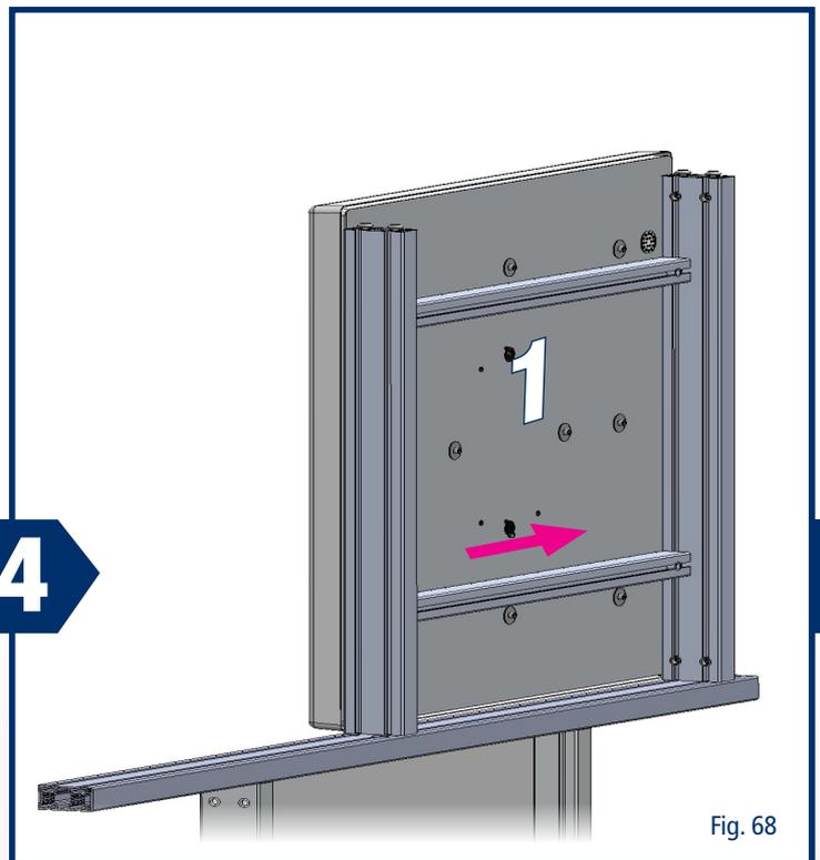
Insérez un module twall® dans les alésages de montage indiqués sur le profilé 80x40x1760 mm du châssis support. Poussez-le vers la gauche de manière à ce qu'il affleure.
