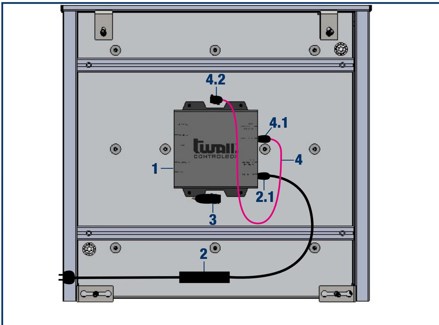
Ci-après une description de la pose des câbles de raccordement pour le module twall® D1 (variante massive).
