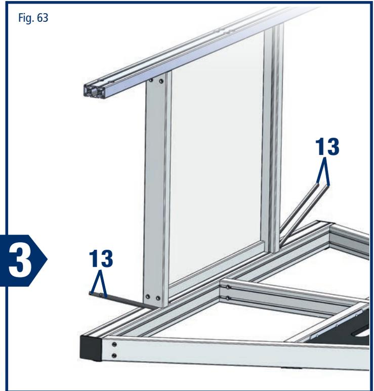
Verschließen Sie die offenen Nuten im Profil (80x80x1760 mm, Fig. 4, Nr. A) des Universalfußes mit 4 Kombiprofilen (Fig. 3, Nr. 13). Montieren Sie abschließend die seitlichen Abdeckkappen.
