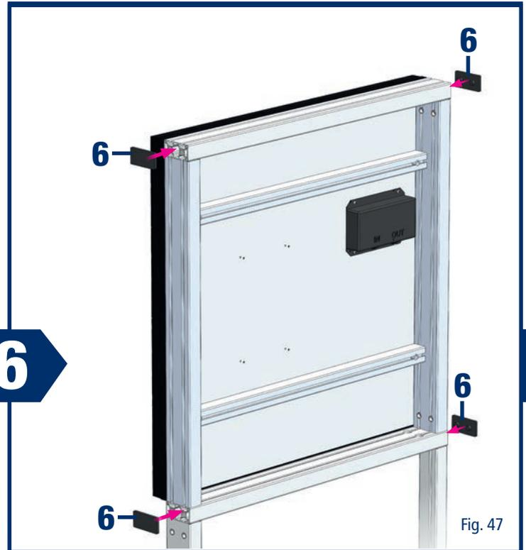
Abschließend bringen Sie die Abdeckkappen an den offenen Stirnseiten der Profile des Trägergestells an, wie auch die Abdeckkappen (Fig. 28, Nr. 6) für das obere Profil 80x40x880 mm.
