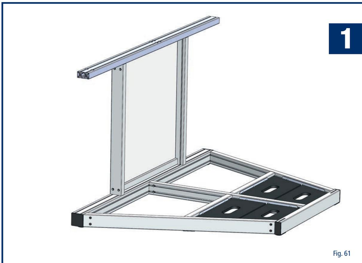
Nachfolgend wird die Montage des Trägergestells auf dem Universalfuß für die twall® A32 beschrieben.
