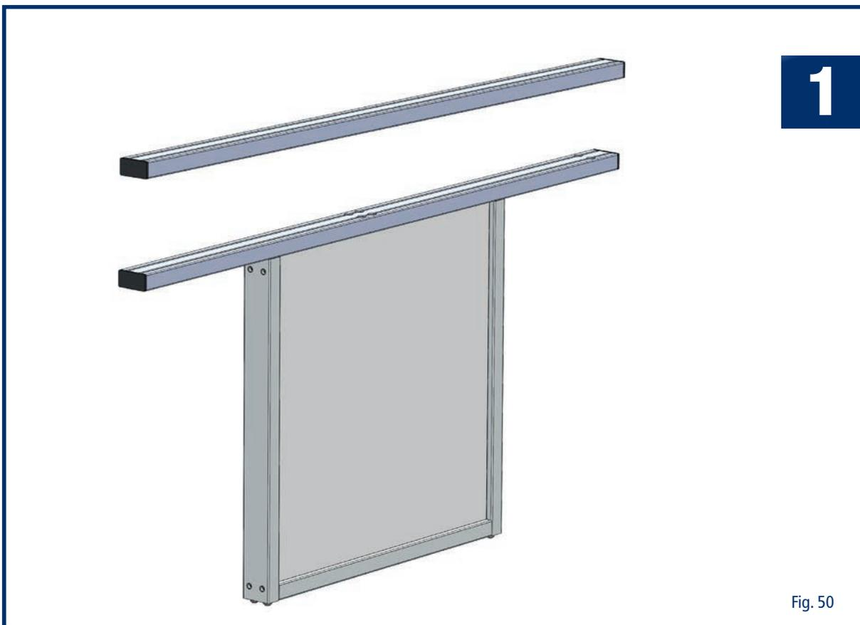
Nachfolgend wird die Montage des Trägergestells für die twall® A32 beschrieben.
