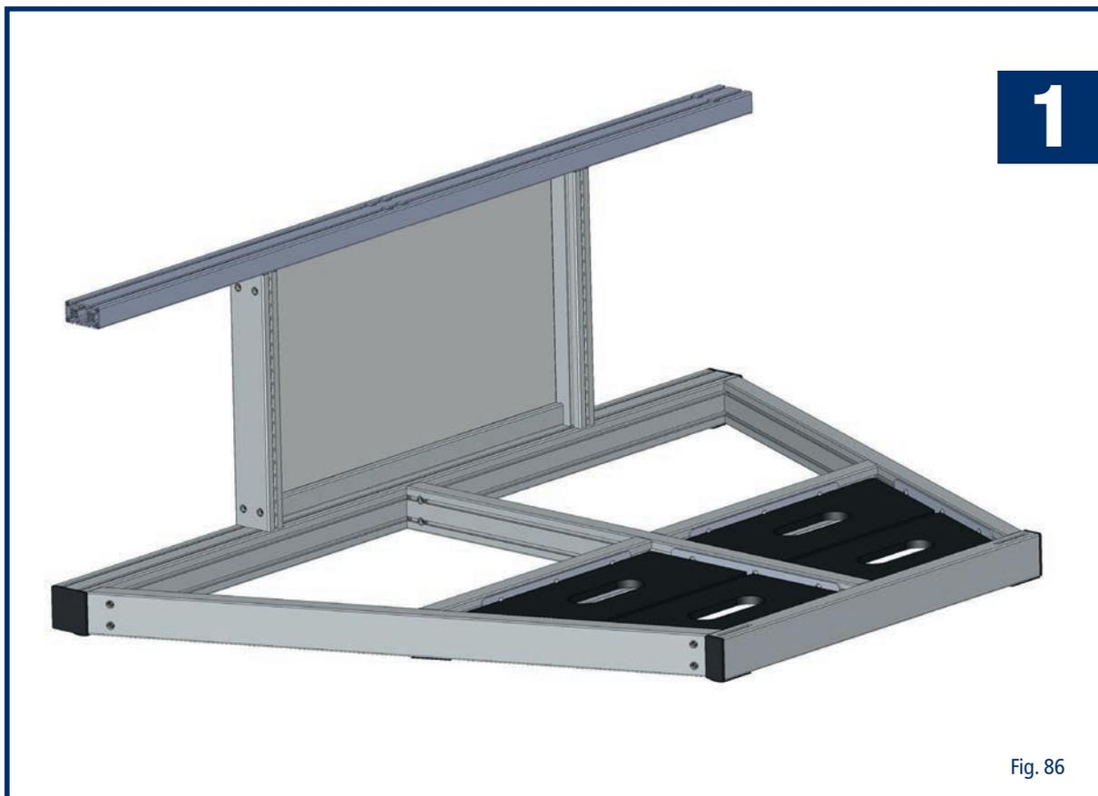
Nachfolgend wird die Montage des Trägergestells auf dem Universalfuß für die twall® A64 beschrieben.
