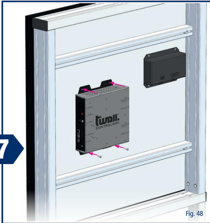
Montieren Sie nun die Controlbox mit den dazugelieferten Schrauben an die Rückseite des twall® A16 Moduls. Nutzen Sie hierfür die vorgesehenen Bohrungen.
