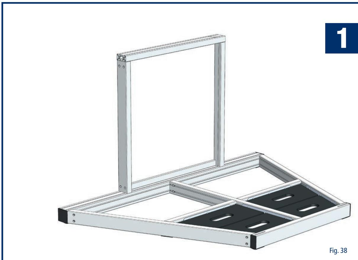
Nachfolgend wird die Montage des Trägergestells auf dem Universalfuß für die twall® A16 beschrieben.
